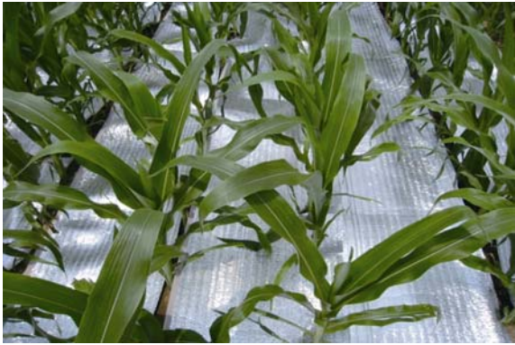
图 6 在玉米下面覆盖铝箔，来屏蔽地表微波辐射
