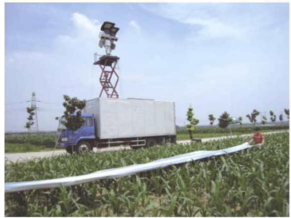
图 4 2008-07-07 在河北清苑用微波辐射仪观测玉米的实验
